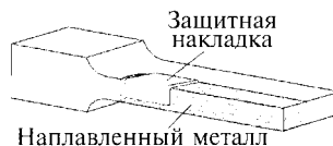
Рис. 2. Усталостный образец с наплавкой и приваренной защитной наплавкой
